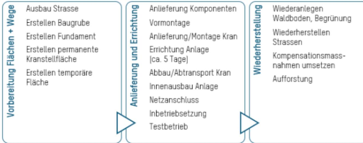
Abbildung 5: Schematische Darstellung der Etappen bei der Errichtung einer Windenergieanlage
