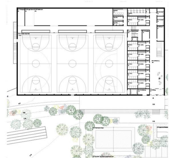
Grundriss Erdgeschoss Dreifachsporthalle
